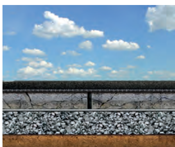
Рехабилитација на бетонски коловози со асфалт
