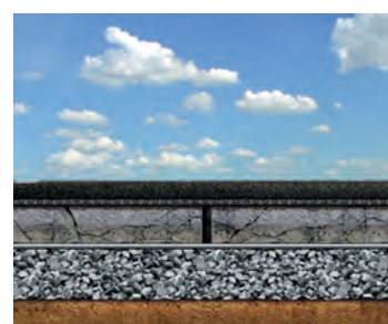
Рехабилитација на бетонски коловози со асфалт
